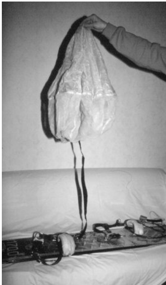
Kuva: Apuvarjon yhdyspunos on mitoitettava siten ettei se ennenaikaisesti vapautuessaan yllä päävarjon avaus- tai laudan irtipäästöjärjestelmään.
