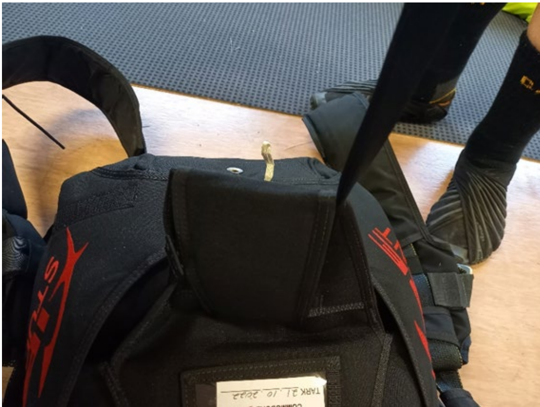
Kuva 4 Tällöin yhdyshihna ei välttämättä pääse vapautumaan läpän alta
