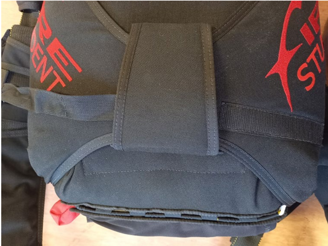
Kuva 3 Tapauksissa yhdyspunos oli tuotu ulos suojaläpän alta virheellisesti vasemmalta
