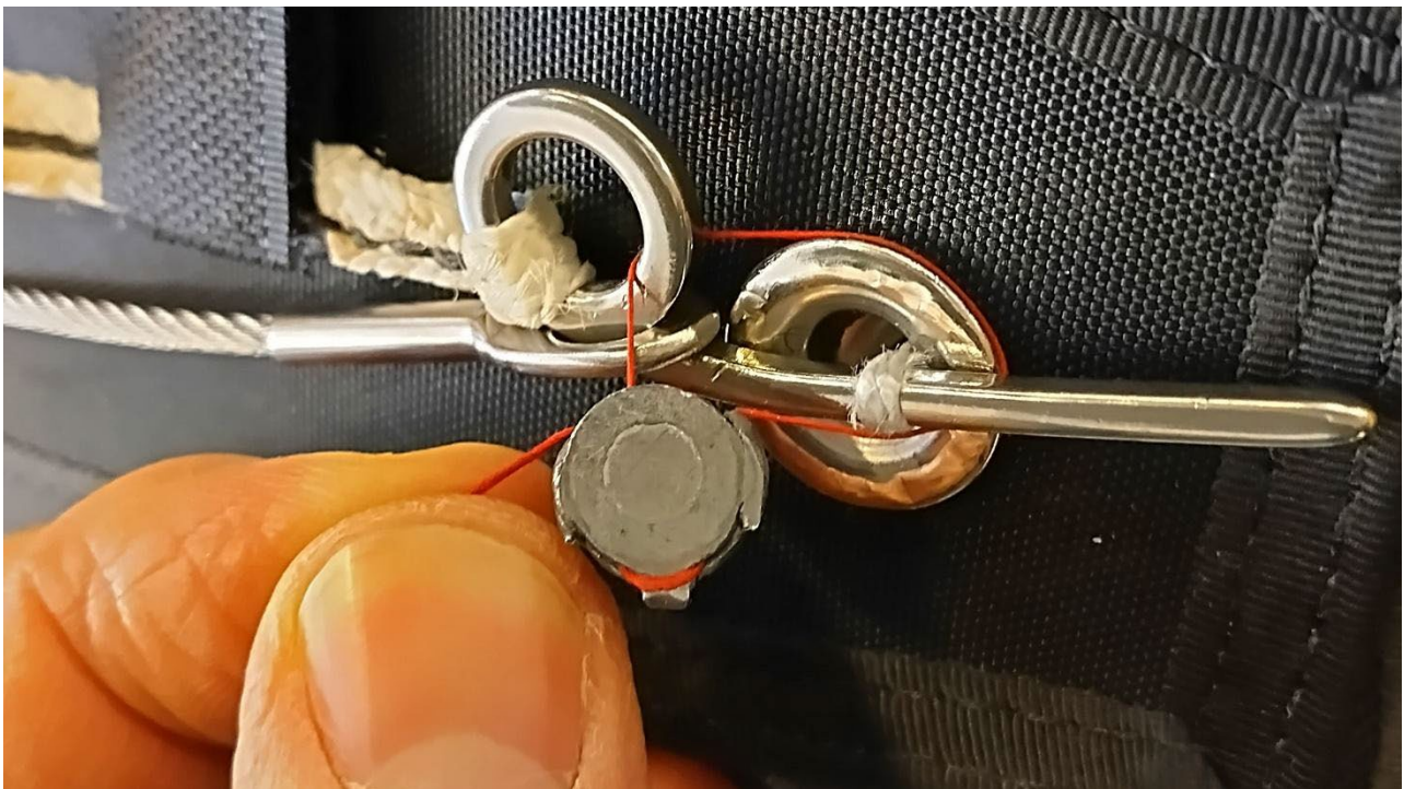
Kuva 6 Ilman leivonpää solmua sinetöity varavarjo.
