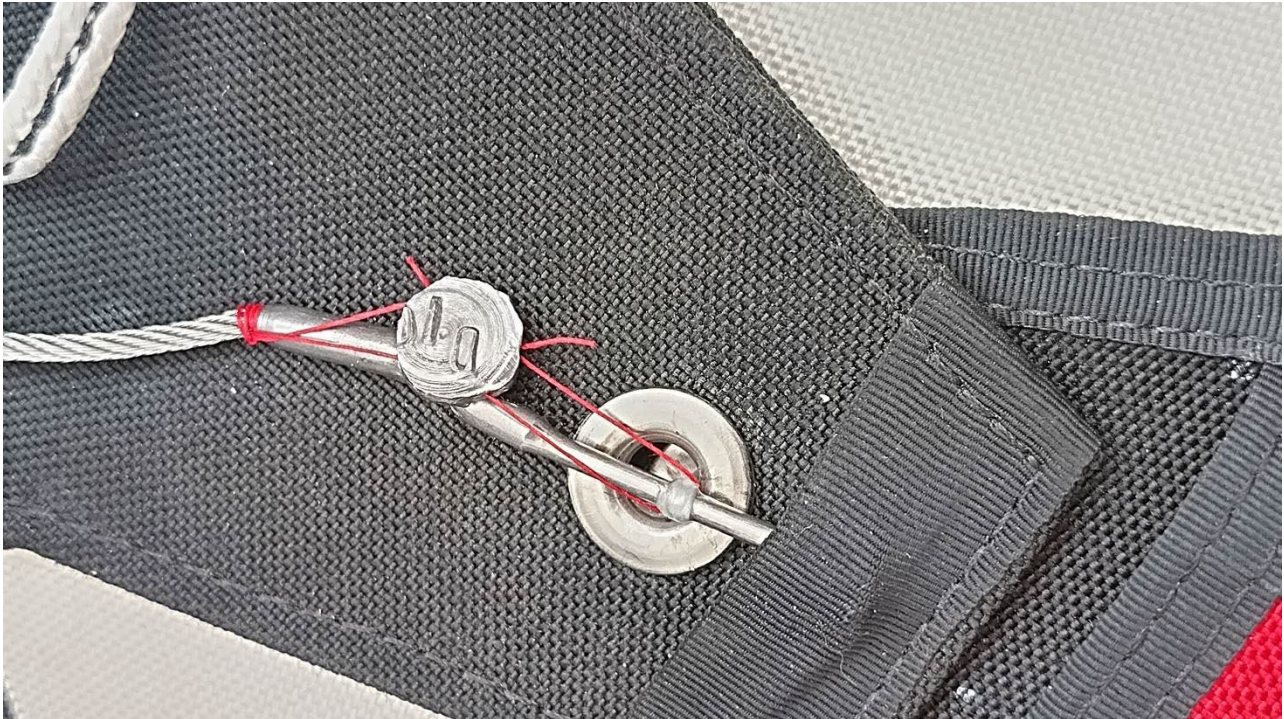
Kuva 2 Pinni oikealle syvyydelle asetettuna.
